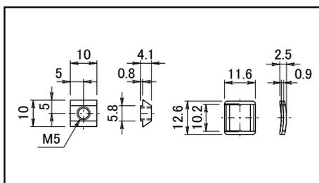
M5ナットをTスロットに挿入しアングルブラケットで取付することが出来ます。
