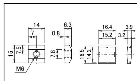
M6ナットをTスロットに挿入しアングルブラケットで取付することが出来ます。
